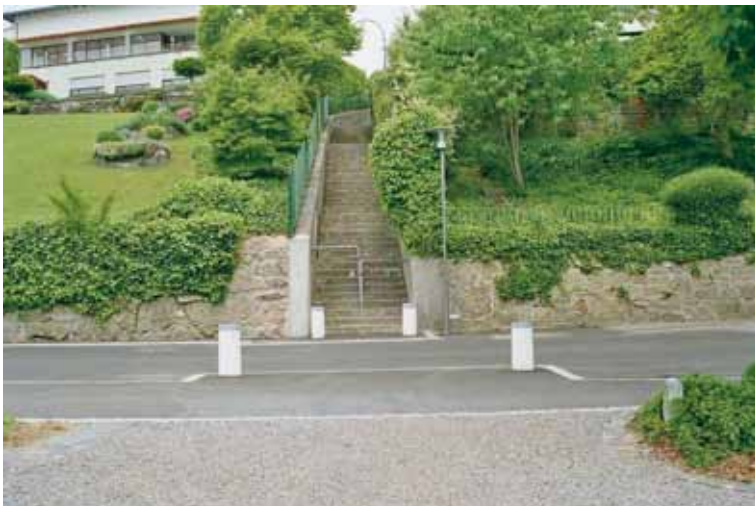
Abbildung 15: Mit Pfosten, Aufpflästerungen und/oder Einengung sind einmündende Fusswege besser erkennbar. (Quelle: Metron Verkehrsplanung AG)
