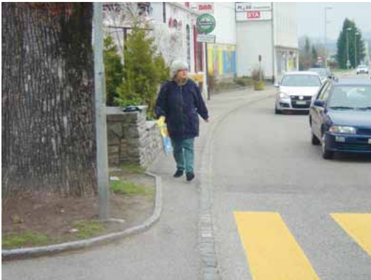
Abbildung 3: Ein ungenügend breiter Gehbereich (Quelle: Metron Verkehrsplanung AG)
